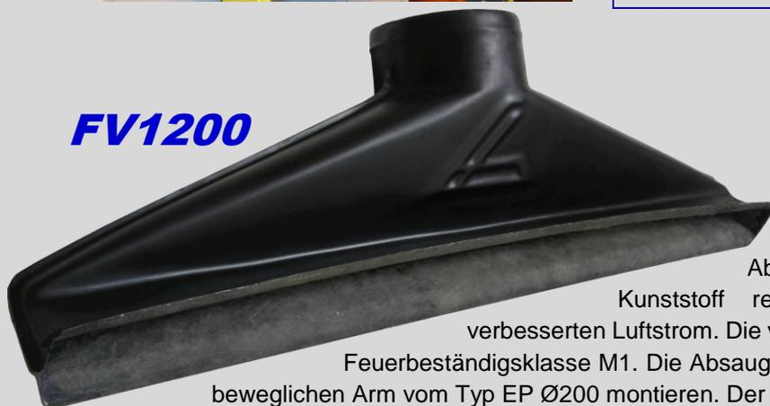
Das besonders durchdachte Design der laminaren Absaugdüsen FV1200 aus Fiberglasverstärktem Kunststoff reduziert den Durchflußwiderstand durch einen verbesserten Luftstrom. Die von ENGMAR entworfene Absaugdüse entspricht der Feuerbeständigkeitsklasse M1. Die Absaugdüse lässt sich direkt am Arbeitsplatz oder an einem beweglichen Arm vom Typ EP Ø200 montieren. Der Anschluß in Ø200 erlaubt ein hohes Absaugvolumen und ermöglicht damit eine größere Distanz zum Emissionsursprung.
