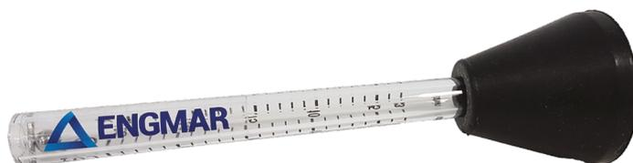
Der Durchflussmesser ermöglicht die Überprüfung der Schutzgasmenge an der Gasdüse. Zu viel Schutzgas bläst den Schweißrauch aus dem Absaugbereich und verschlechtert so das Absaugergebnis. Das Gasvolumen sollte proportional zum Durchmesser der Gasdüse sein: 1 l/min pro mm Gasdüsendurchmesser. Zum Beispiel: 14 l/min für eine Gasdüse mit Durchmesser 14 mm.
