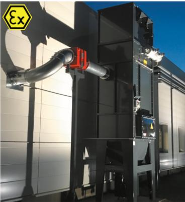
Die zentralen Absauganlagen für Niedervakuum von **ENGMAR** sind für metallhaltige Stäube geeignet. In der Vorkammer werden die größten Partikel gefiltert. Anschließend fließt die Luft durch die Filterkartuschen. Zertifizierte ATEX-Filter sind ebenfalls erhältlich.
