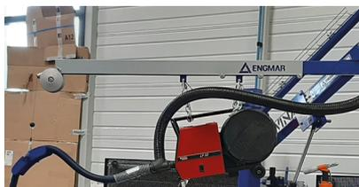
Der Load Balancer wird am Schwenkkran TWINAXE montiert und gewährleistet eine zusätzliche Aufhängung des Absaugbrenners sowie einen verbesserten Drahtvorschub.
