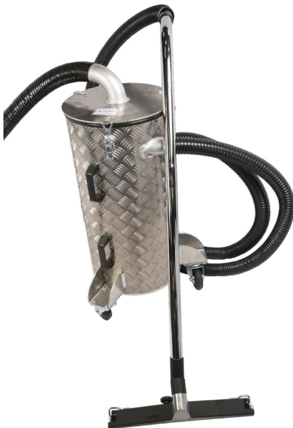
Dieser Industriesauger besteht aus einem Aschetank, der an ein mobiles Absauggerät oder die zentrale Absauganlage angeschlossen werden kann, dem Verbindungsschlauch, sowie dem Bürstenset für die Fußbodenreinigung. Der Aschetank filtert die größten Schmutzpartikel und verhindert eine Beschädigung des Absauggerätes bzw. der Absauganlage. Der Industriesauger ist mit Rädern ausgestattet. Bei der Verwendung ist passender Atemschutz zu tragen.
