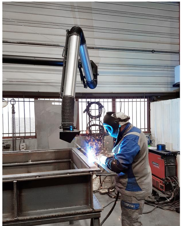
*Absaugarm Armoweld und laminare Absaugdüse Revflow*
