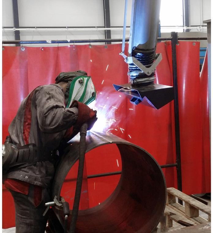
*Absaugarm Armoweld und laminare Absaugdüse Revolveflow*
