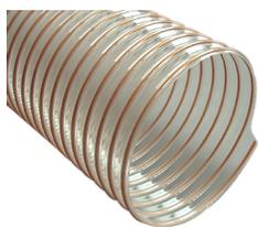
Die von **ENGMAR** angebotenen Absaugschläuche sind aus Polyurethan und sind durch Stahlspiralen verstärkt. Sie sind dadurch besonders stabil und resistent gegen Abrieb, bleiben aber gleichzeitig sehr beweglich.
