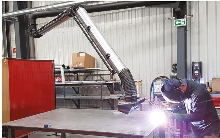
Um die Beständigkeit der tragenden Struktur trotz der Schweißrauche zu gewährleisten, wurde diese als Integralteil aus Stahl mit anodisierter Oberfläche gefertigt.
