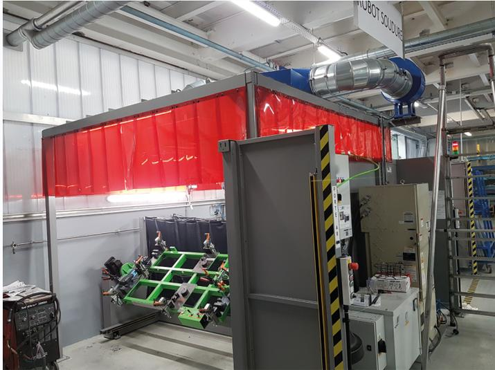
**ENGMAR** konzipiert und installiert Strukturen mit laminaren Absaugdüsen, die die Schweißzone effizient abschirmen. Eine Vermischung der Schweißrauch mit der Umgebungsluft wird dadurch minimiert.
