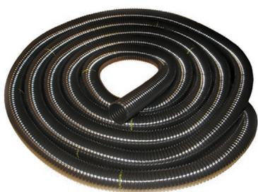
Unser Verbindungsschlauch P600 mit einem Durchmesser von 60 mm ermöglicht den Anschluss der Absaugbrenner an das Absauggerät sowie des Absauggerätes an den Schornstein. Für die laminare Absaugdüse CHD40150 bietet sich der Absaugschlauch T400 mit einem Durchmesser von 40 mm an. Beide Varianten bestehen aus Metallspiralen und sind mit verstärktem Polyurethan ummantelt.
