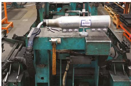
Mit Hilfe der Prüfvorrichtung von **ENGIMAR** können das Absaugvolumen sowie die Geschwindigkeit an der Gasdüse des Absaugbrenners überprüft werden.
