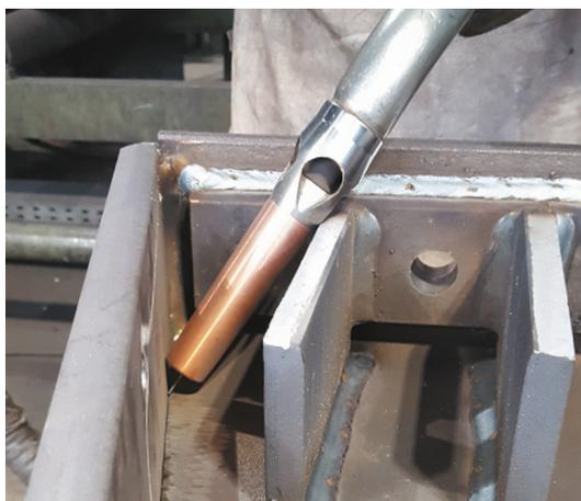
Engspaltdüsen sind für die Modelle 300, 350 und 380 verfügbar und gewährleisten die Absaugung selbst in engen Winkeln. Die Engspaltdüsen sind 4 cm länger, als die Standardgasdüsen.
