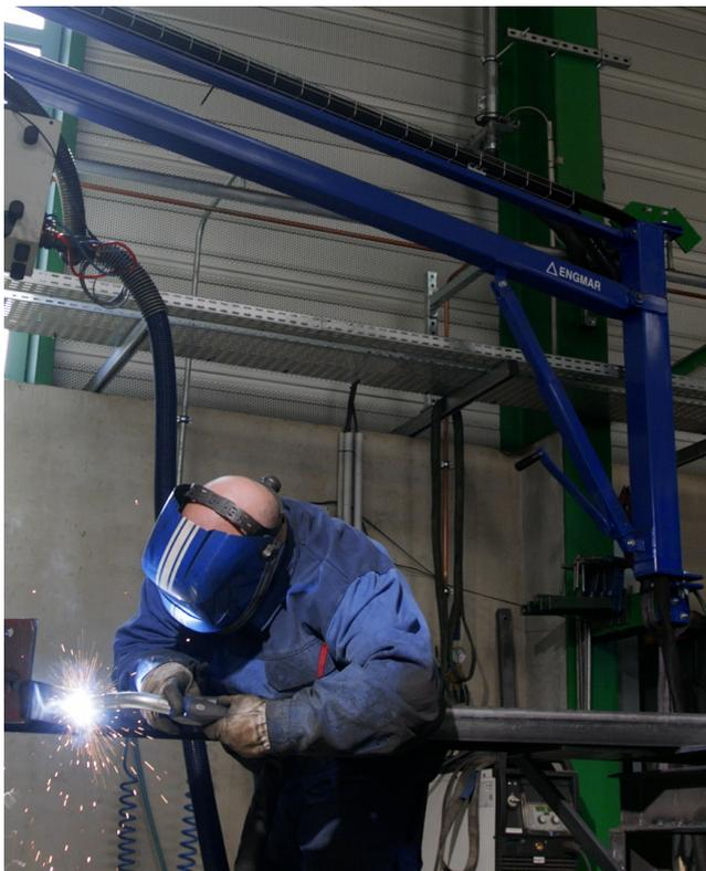
*Schwenkran mit Absaugbrenner*
