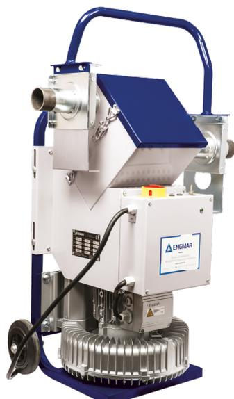
Mit Hilfe des BBPASS kann der Absaugluftstrom bei einem Absauggerät mit zwei Anschlüssen auf jeweils einen der Anschlüsse umgelegt werden. Der andere Anschluss ist dabei geschlossen. Der BBPASS eignet sich z.B. für die Verwendung eines Absauggerätes mit zeitweiser Verwendung eines Absaugbrenners und einer laminaren Absaugdüse am selben Arbeitsplatz. Ein Umbau entfällt hier und spart Zeit.
