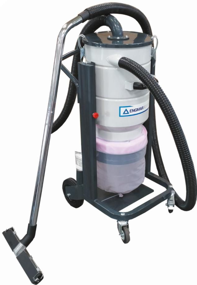
Der Industriesauger KBCNL besteht aus einem Aschetank, der an ein mobiles Absauggerät oder die zentrale Absauganlage angeschlossen werden kann, dem Verbindungsschlauch, sowie dem Bürstenset für die Fußbodenreinigung. Der Aschetank ist mit einem Abfallbeutel ausgerüstet und filtert die größten Schmutzpartikel. So wird die Beschädigung des Absauggerätes bzw. der Absauganlage verhindert. Der Industriesauger ist mit Rädern ausgestattet. Bei der Verwendung ist passender Atemschutz zu tragen.
