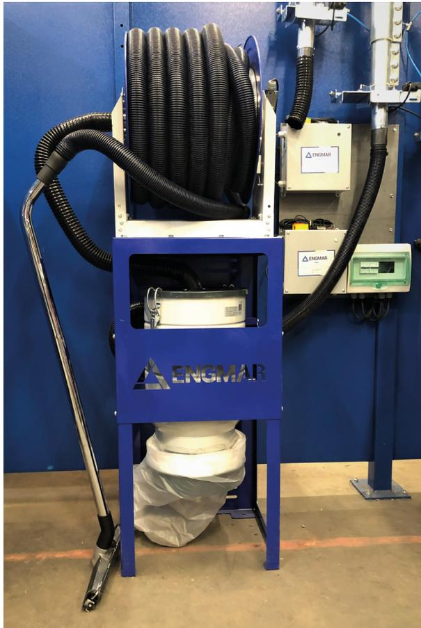
Der Industriesauger KBCNF besteht aus einem fest montierten Industriesauger und einer Schlauchtrommel.
